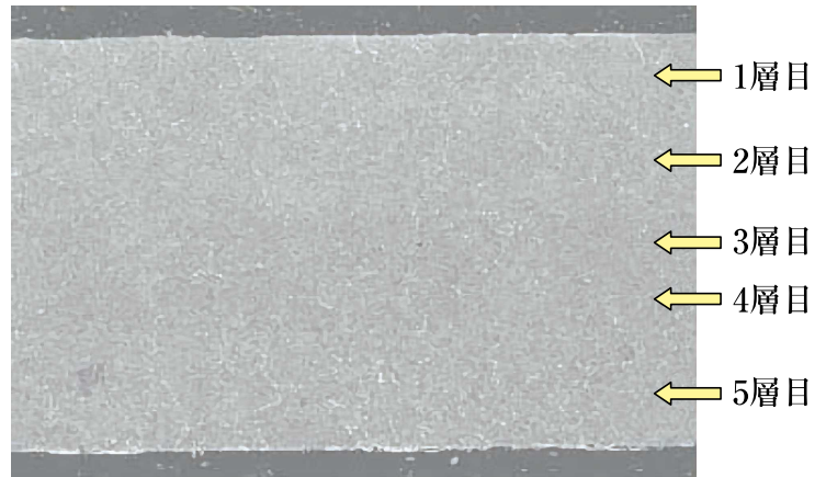
SUS304、拡散接合における温度/荷重の関係
